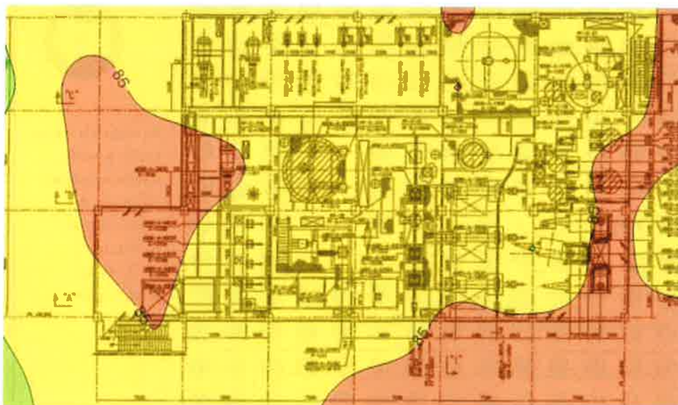
รูปที่ 34 แผนผังแสดงเส้นระดับเสียง (Noise Contour Map)บริเวณ 2 nd CP Unit โครงการโรงงานผลิต Polyethylene Terephthalate (PET) บริษัท ไทยเพ็ท เรซิน จำกัด
